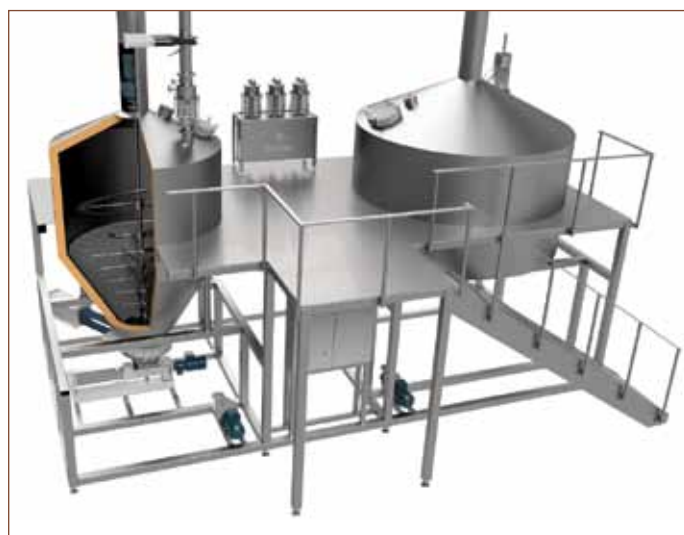
Abb. 1 50-hl-Kompaktsudhaus, Maisch-Läuterbottich mit Spezialrührwerk im Querschnitt (li.) und Whirlpoolpfanne (re.)
